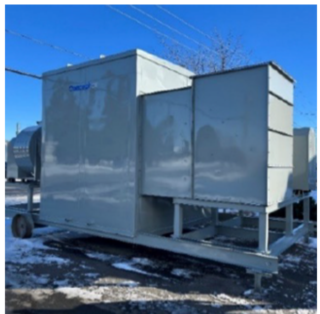
Figure 2c : Exemple intégral de roue thermique incluant le boîtier de l'équipement.
